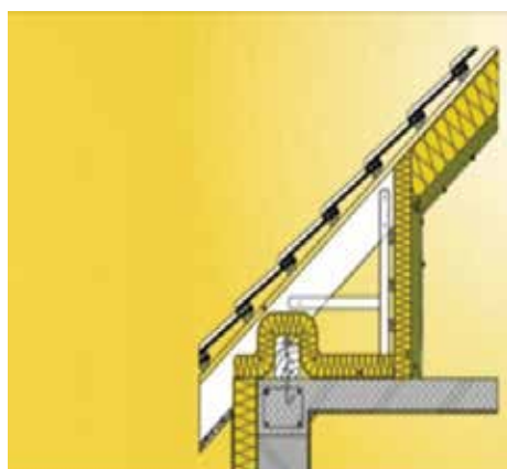
Figura 25. Stratul de vată minerală în spatele zonei de placare verticală
