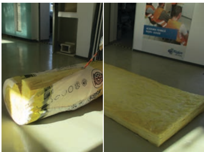
Figura 12. Dezambalarea unei role de vată minerală
